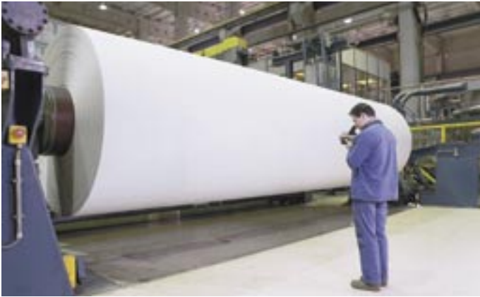
Bilder 3 und 4: Im infraroten Spektralbereich wird durch Temperaturunterschiede die Feuchtigkeitsverteilung auf dem Papiernetz sichtbar, das mit einer Geschwindigkeit von ca. 1 600 m pro Minute am Thermografen vorbeischießt
